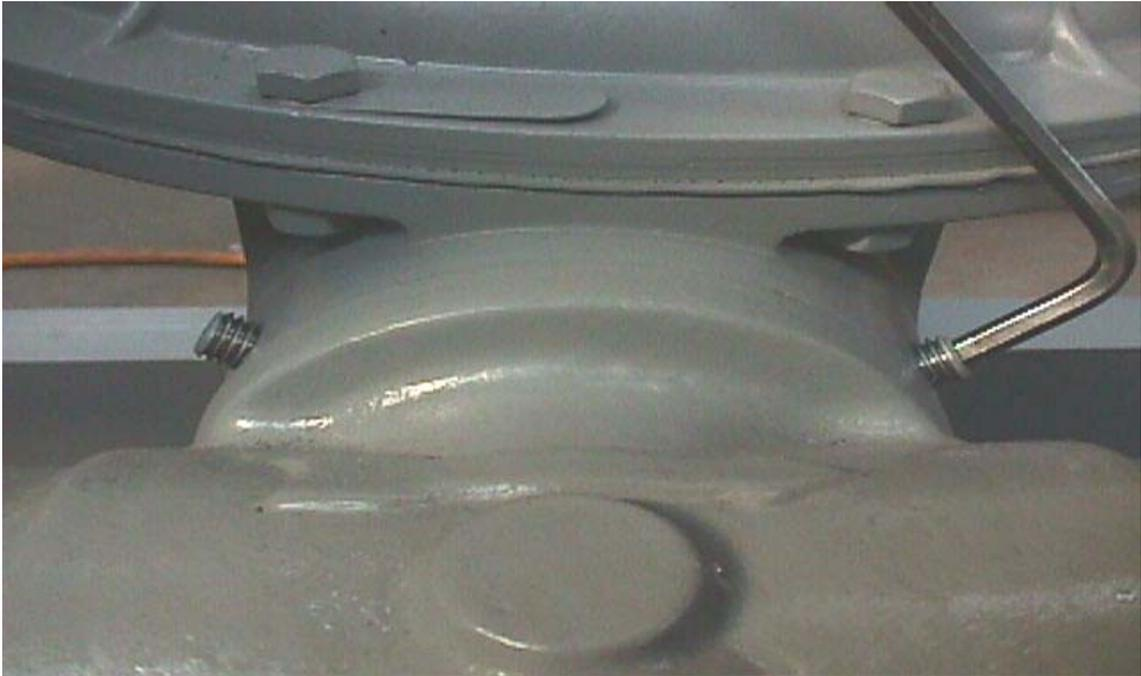
그림10: Body부 압력조절 부분과 Head 유량조절 연결 Bolt(3개)를 육각렌치로 조어 준다
