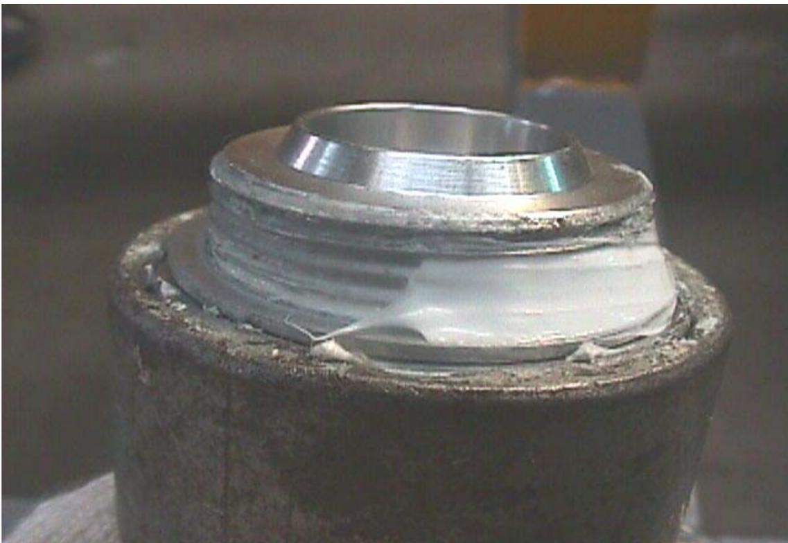
그림7: 교체할 오리피스(1/4")에 Orifice Gasket를 부착하고 구리스를 칠한다.
