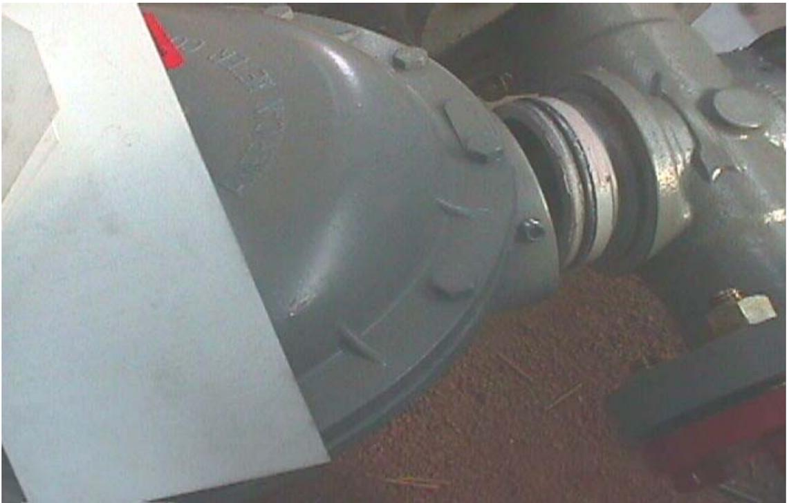
그림9 : Body부 압력조절 부분과 Head 유량조절 부분을 조립하는 그림
